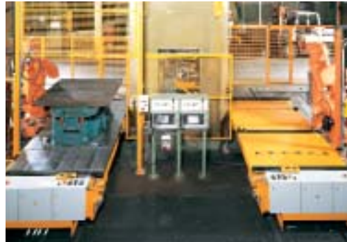
Werkzeugwechsel in einer Pressenlinie. Zwei DILOS SHUTTLE arbeiten zusammen – die Werkzeuge (18 t) werden 'einfach durchgeschoben'
