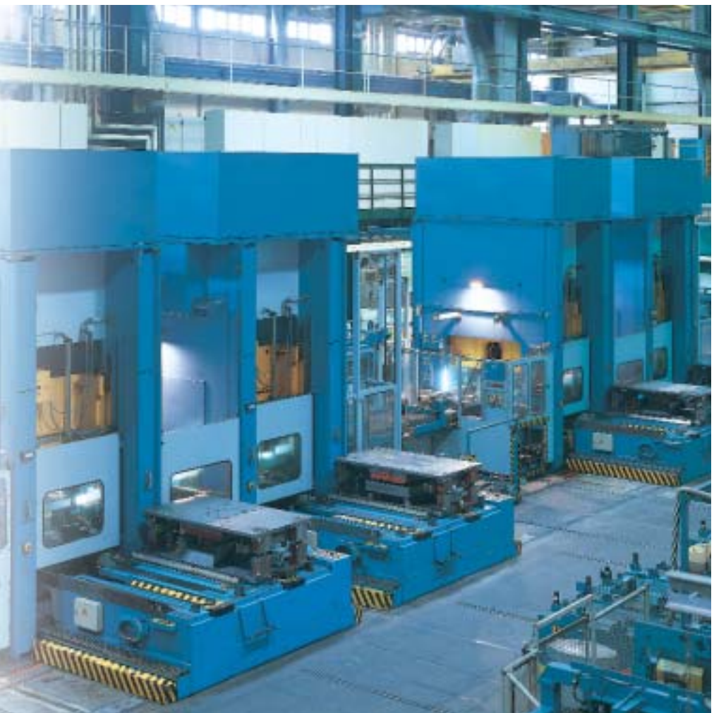
Komplettausstattung einer Pressenlinie mit DILOS SHUTTLE in Tandemausführung (5 t)
