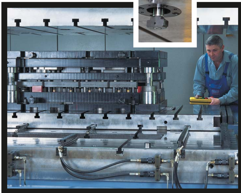
Wechselplatten-Technik. Pressentisch-Ausstattung DILOS SlipGrip TR 28, Pressenstößel-Ausstattung DILOS Schwenk-Zugspanner
