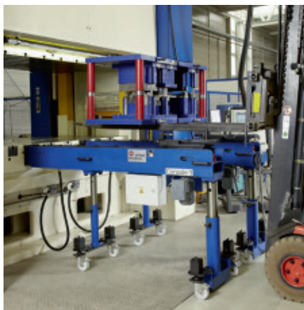
Beladen der Konsole zum Werkzeugwechsel
