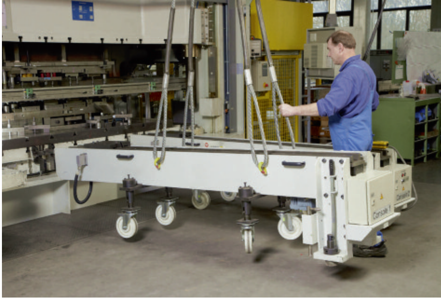
Transport der Konsolen mittels Hallenkran oder auf den Rollen
