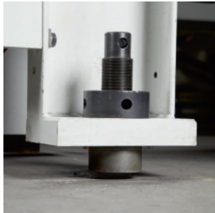
Konsolenstützfuß ohne Belastung / Werkzeug
